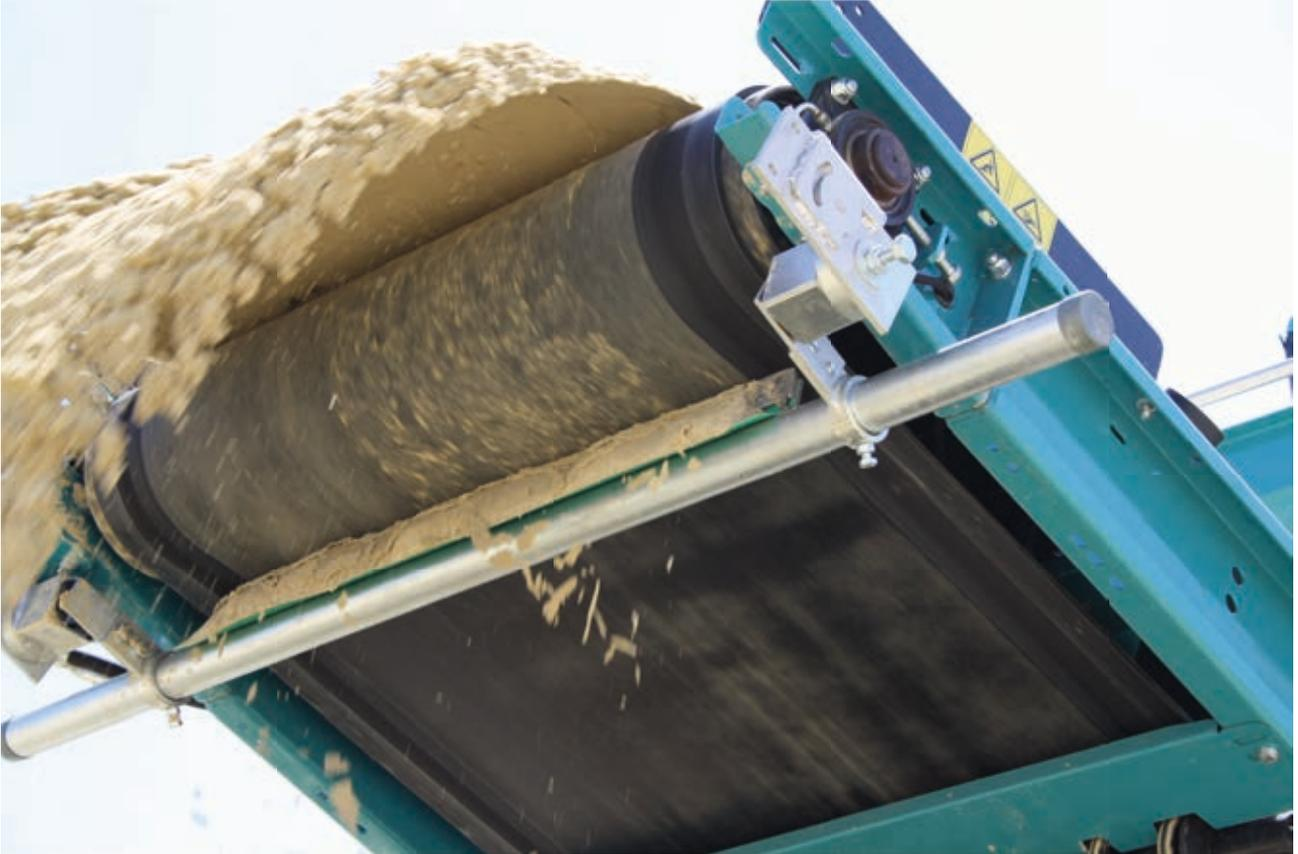
Mehrlagen-Förderbänder werden zum Transport von mittelschweren bis schweren Materialien eingesetzt. Die Standardkonfektionen bestehen hierbei aus einem sogenannten EP-Kreuzgewebe, das durch Gummilagen gedämpft und von einer abriebfesten Deckplatte geschützt ist.
